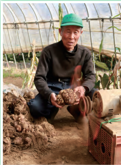
モーターと野菜ネットで自作した毛羽取り機
